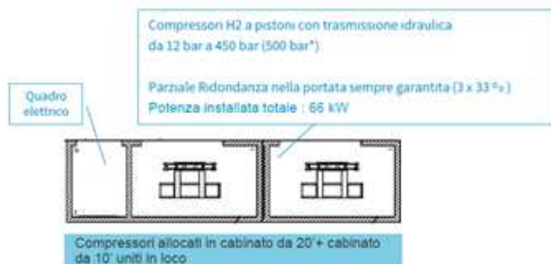
Figura 18. Configurazione tipica del container "compressione"(immagine esemplificativa)
